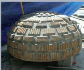
Las piezas antidesgaste laminadas ofrecen una extrema protección en aplicaciones extremas.
