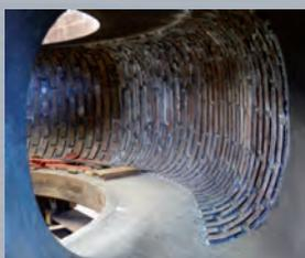
Gracias a la unión metalúrgica por difusión, las piezas antidesgaste laminadas poseen propiedades superiores en comparación con construcciones mecánicas y bimetálicas. Estas piezas resisten las más difíciles condiciones de choques y abrasión.
