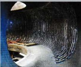
Durch die metallurgische Diffusionsverbindung haben die laminierten Verschleißteile überlegene Eigenschaften im Vergleich zu mechanischen und bimetalischen Konstruktionen. Sie widerstehen den schwierigsten Stoß- und Abriebbedingungen.
